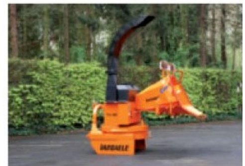
TVI 180 P; mit Schlepperantrieb, um 270° schwenkbar (Option)
