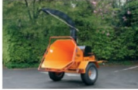
TVI 180 P; mit Schlepperantrieb, Fahrwerk auf Rädern für den langsamen Transport (Option)
