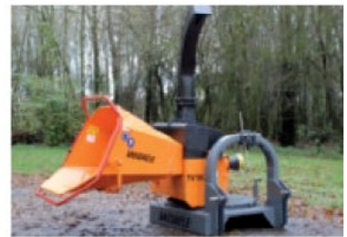
TVI 180 P; mit Schlepperantrieb, um 2 x 90° schwenkbar (Option)
