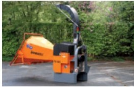
Maschine mit 3-Punkt-Anhängung, standardmäßig über Schlepper angetrieben
