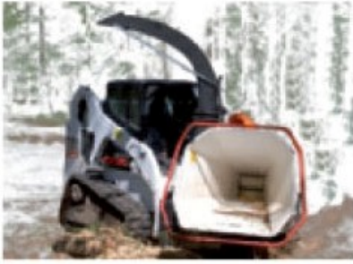
Maschine mit Hydraulikantrieb für Geräteträger
