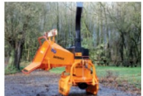
TV20-26 P ; Accionada por tractor con posibilidad de giro de 270° (opcional).
