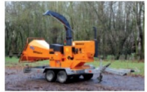
Unidad accionada por motor diesel sobre remolque de gran velocidad.
