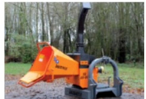
TV20-26 P ; Accionada por tractor con posibilidad de giro de 2 x 90° (opcional).
