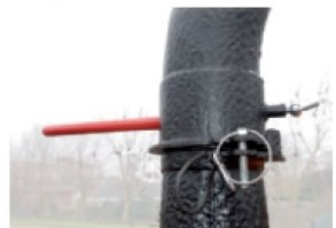
Capacidad de giro de 360° de la chimenea de escape (seguridad), sistema de bloqueo para transporte incluido.
