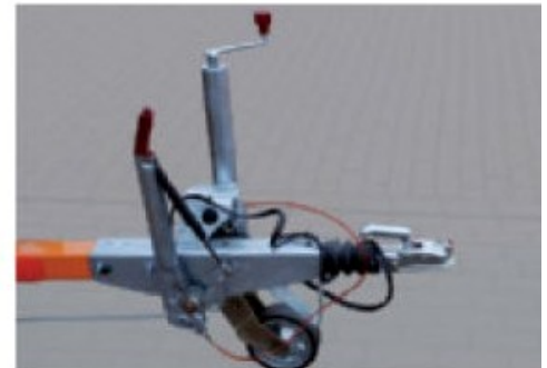
TVI 20 D; Remolque con sistema de frenado autoblocante.
