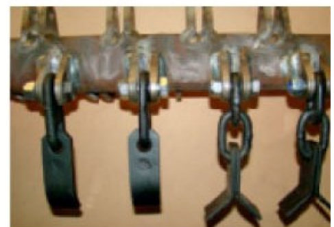
Gepatenteerde “VD” klepels (patent n° 796173) = enkele klepels voor grover werk; dubbele klepels voor fijner maaiwerk.
