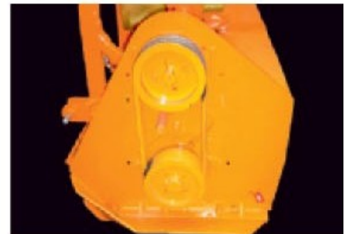
Overbrenging door zware riemaandrijving, zonder riemspanner.
