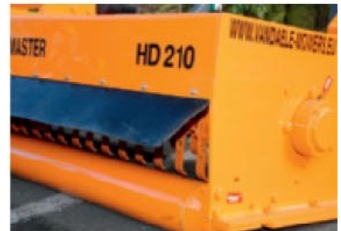
Zware rotorlaging; grote diameter looprol; stevige constructie.
