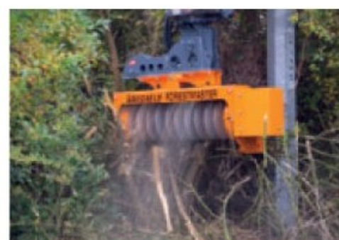
Maaikop met kooirotor en hamers voor snoeien en maaien tot 10cm diameter.
